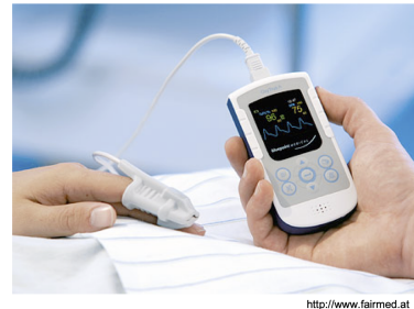
Prinzip der transkutanen Sauerstoffsättigungsmessung (SpO 2 ): Pulsoximetrie
