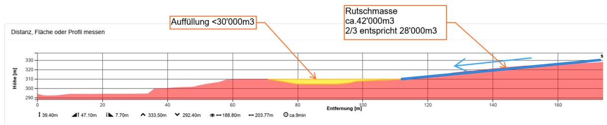
Bild 11: Ausschnitt (unterer Teil) Längensprofil mit Rutschmasse < Auffüllmasse
