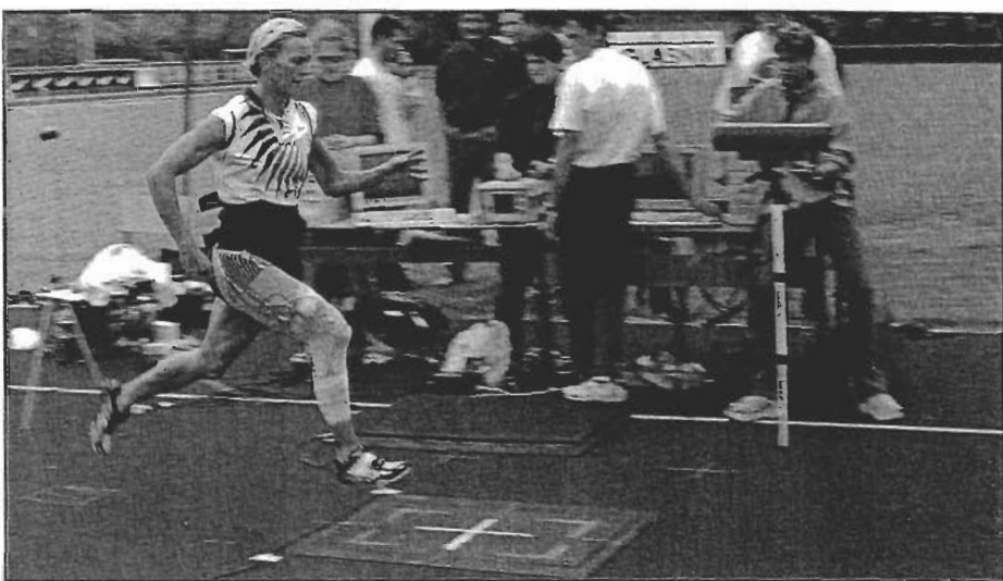
Versuchsaufbau zur Messung der Reaktionskräfte und der elektromyographischen Aktivität beim Sprint
