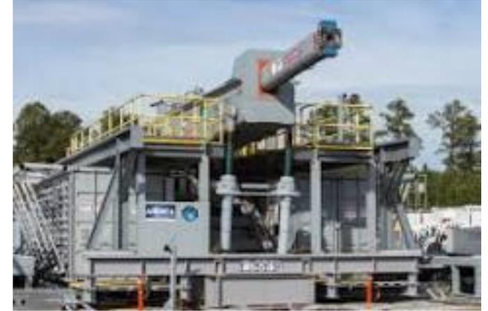
In den letzten Jahrzehnten wurden sogenannte «Railguns» entwickelt. Dort wird ein starker Strom genutzt um ein Magnetfeld zu erzeugen, welches dann über die Lorentzkraft ein Projektil beschleunigt.
