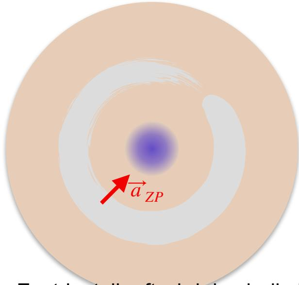
Zentripetalkraft wird durch die Haftreibung auf der Drehscheibe aufgebracht.
