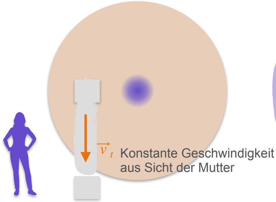
Sobald sich der Karton im rotierenden System nach aussen bewegt, kommt der Coriolis term zur Beschleunigung dazu.
