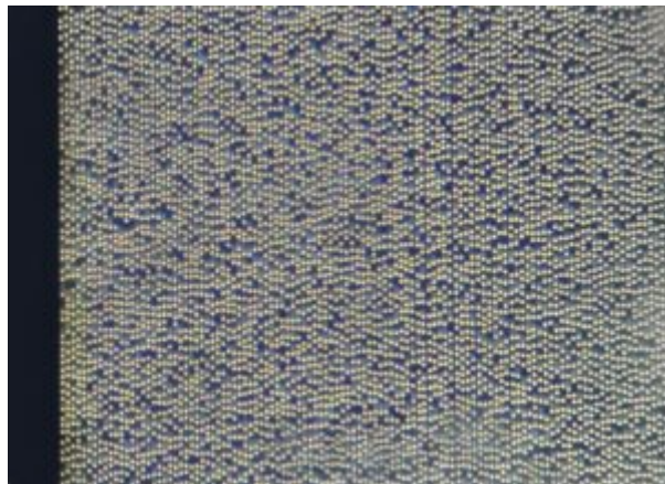
Abbildung 1.8 - CD Innenrand bei ca. 1000 fach, Auflicht.
